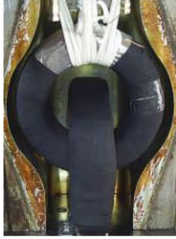
Şekil 2.8: Reçine kalıbına yerleştirilmiş bir gerilim transformatörü
